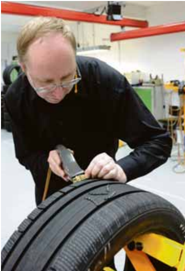
Reifenschnitzer Josef Lachnitt schnitzt im Werk mit einem Messer ein Profil in einen Autoreifen.
