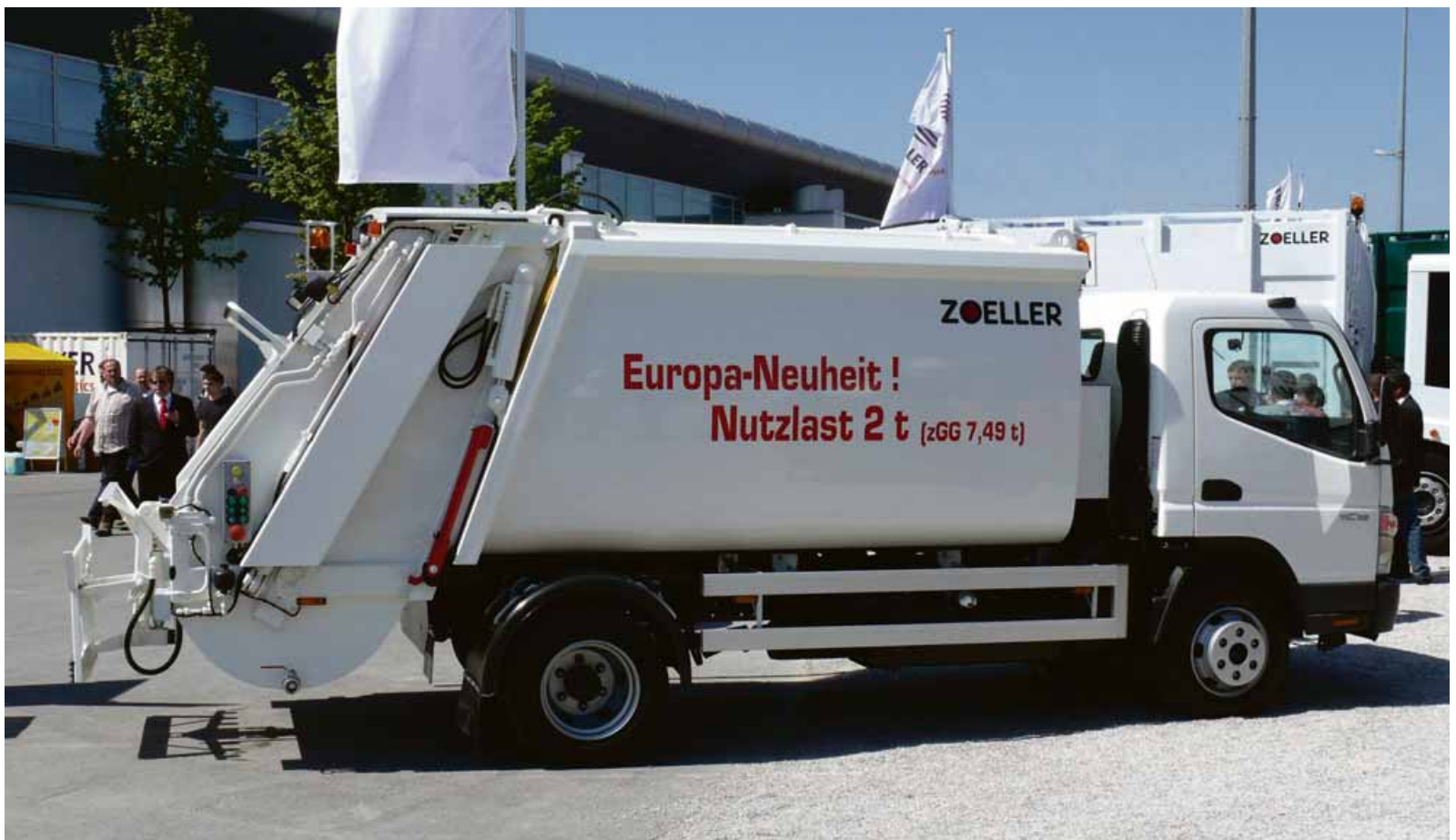
Dank Behälterlifter, Verdichtereinheit und Ausstoßschild ist der MICRO XL ein vollwertiges Sammelfahrzeug. Foto: ZÖLLER KIPPER / Mainz / D
