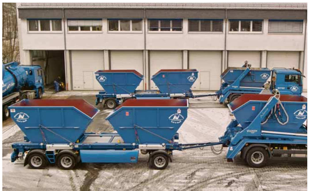
Die Ausstattung OK beim Absetzkipper TAK erspart das mühsame einhängen der Ketten bei der Behälteraufnahme.
