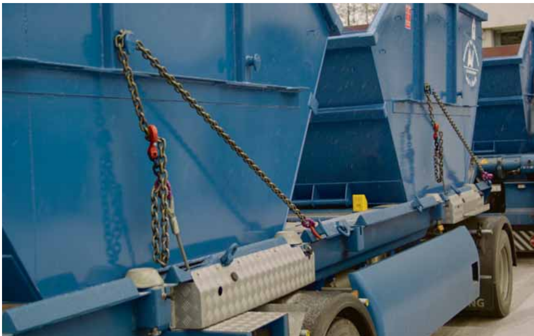
Die semiautomatische Behälterverriegelung beim Anhänger erlaubt eine schnelle und zuverlässige Sicherung der Absetzmulden.
